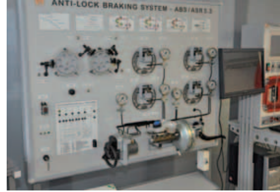
Trainingsystem für die Bremskraftregelung bei ABS und ASR
