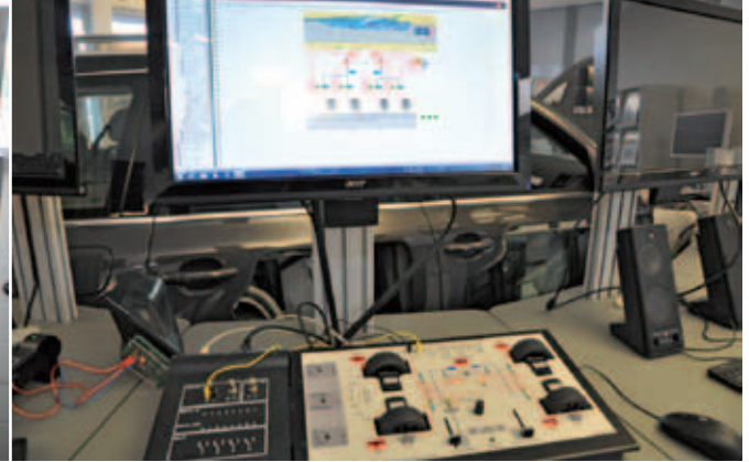
Das hier abgebildete Lernsystem Uni-Train dient zur Vermittlung von Systemkenntnissen an ABS- und ASR-Systemen
