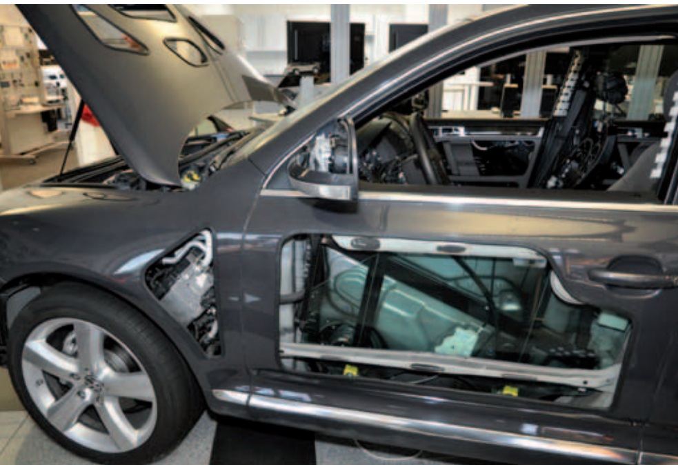
An diesem VW Touareg im Intea-Schulungszentrum können unterschiedliche Fehler simuliert werden. Nahezu alle Steuergeräte und Sensoren sind zugänglich und einzeln ansteuerbar
