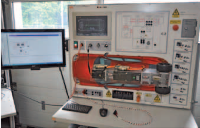
Car-Train nennt sich das mobile Schulungssystem. Das abgebildete System dient für Hochvoltschulungen und kann sieben verschiedene Antriebskonfigurationen simulieren
