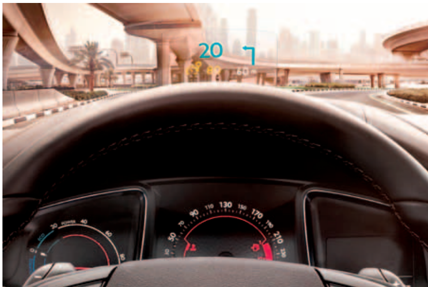
Headup-Display: einschwenkendes Plexiglasэлемент statt in Querschnitt und Beschichtung angepasste Frontscheibe
