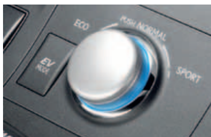
Fahr-Modi: Eco, Normal, Sport und EV (= Electric Vehicle) zur Anpassung des Antriebs an die Ansprüche des Fahrers
