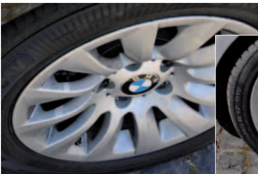
Deutliche Staubschicht beim konventionellen Belag (l.) nach sechs Vollbremsungen
