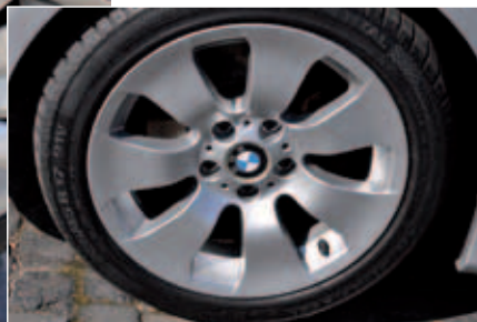
Deutliche Staubschicht beim konventionellen Belag (l.) nach sechs Vollbremsungen
