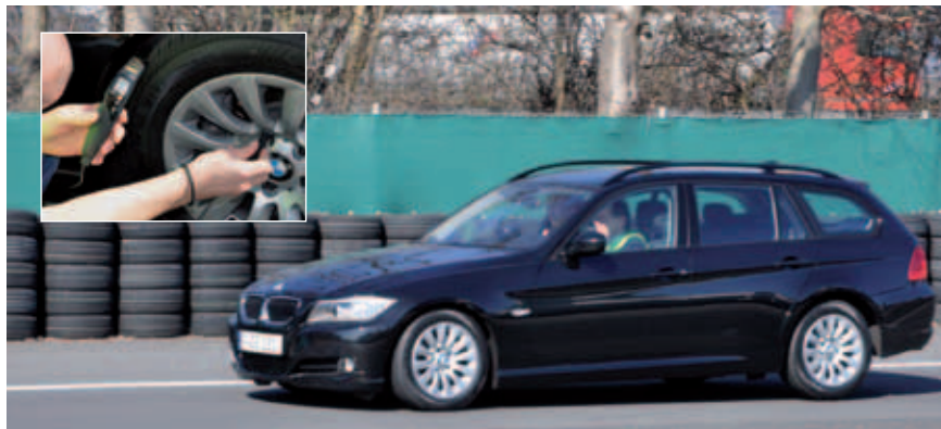
Auch nach mehreren Vollbremsungen aus Tempo 100 liegt die Bremstemperatur unter 200 Grad Celsius
