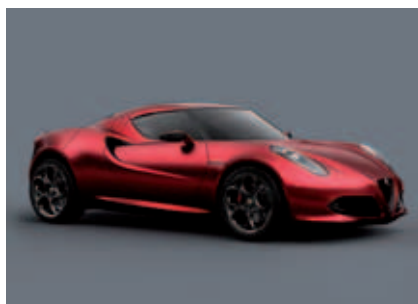
Alfa Romeo 4C: aufgeladener Heckmittelmotor, Doppelkupplungsgetriebe, Heckantrieb, ab 2012
