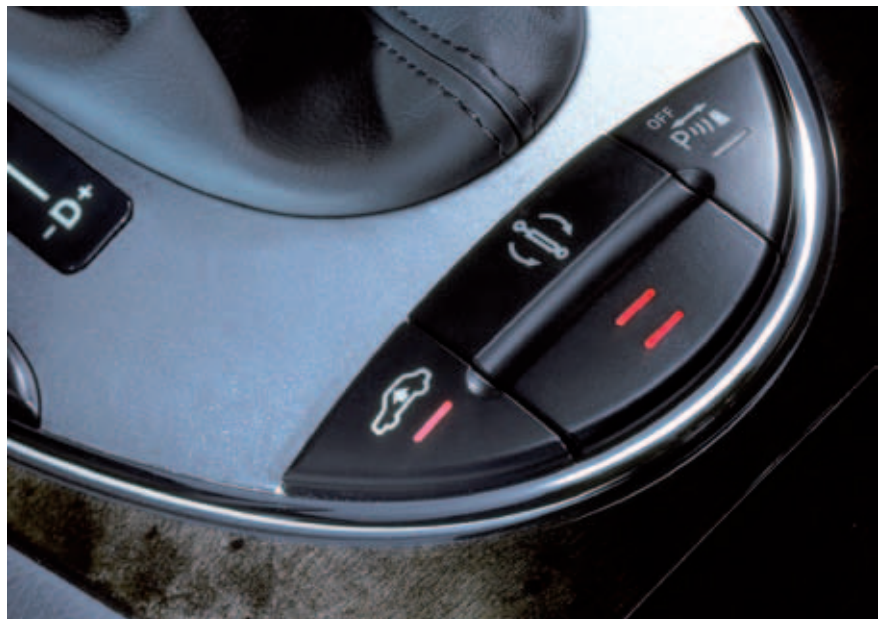
Bedientasten der AIRmatic in der Mercedes-Benz E-Klasse (W211)
