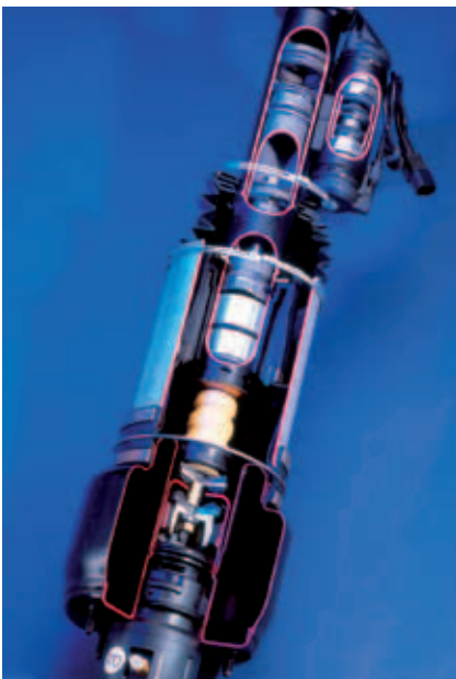
Schnitt durch ein Luftfederbein
