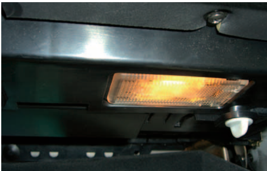
Häufige Fehlerquelle neben hängenden Relais, defekten Elektronikmodulen, Autotelefonen/Freisprecheinrichtungen, defekten Radios, falsch angeschlossenen Endstufen, nicht vollständig ausgebautem Zubehör etc.: defekte Schalter
