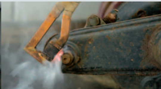
Auch bei klassischen Verschraubungen mit Schraube und Mutter erleichtert das Erhitzen das anschließende Lösen der Verbindung
