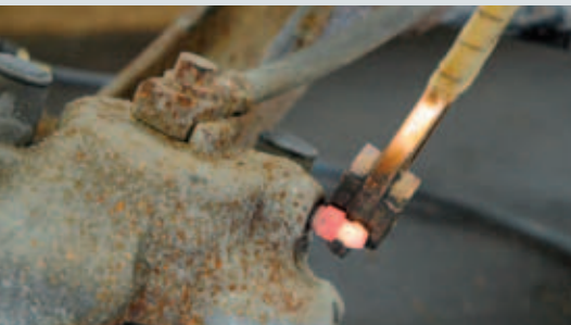
Wenn sich der Entlüftungsnippel am Bremssattel nicht lösen lässt, hilft das gezielte Erhitzen. So wird ein Abbrechen vermieden
