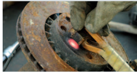
Mit dem Induktionsheizgerät lässt sich die Befestigungsschraube einer Brems Scheibe gezielt erwärmen, wodurch sie sich stark ausdehnt
