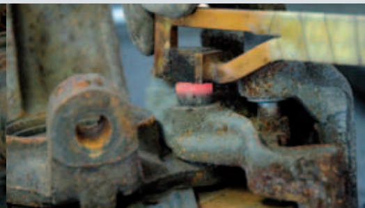
Bei langen Schrauben muss der Induktor mehrfach hintereinander angesetzt werden, bis die Schraube auf ganzer Länge erhitzt ist
