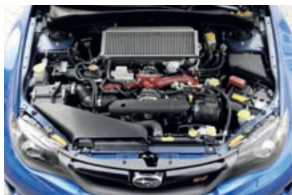
Der aufgeladene 2,5-Liter-Boxer-Ottomotor produziert die Maxima 407 Newtonmeter und 221 Kilowatt
