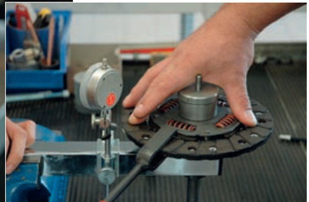
Messung des Planschlags einer Kupplungsscheibe, Nachjustieren des Belags mit einer Gabel
