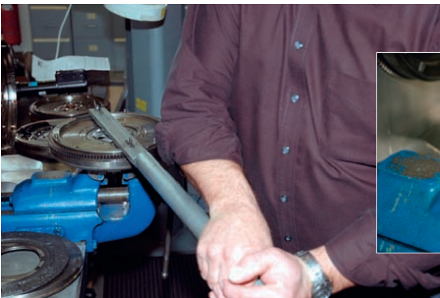
Die Anordnung für die Verdrehprüfung des ZMS lässt sich ohne großen Aufwand selbst anfertigen
