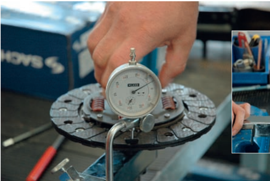
Messung des Planschlags einer Kupplungsscheibe, Nachjustieren des Belags mit einer Gabel
