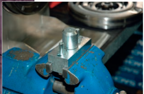
Die Anordnung für die Verdrehprüfung des ZMS lässt sich ohne großen Aufwand selbst anfertigen
