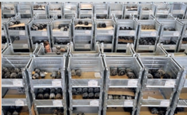
Basis von allem: Im Bosch Reman-Werk in Göttingen ist das zentrale Sortier- und Corelager mit 6.300 Sortierarbeitsplätzen für die unterschiedlichsten Altteiletypen
