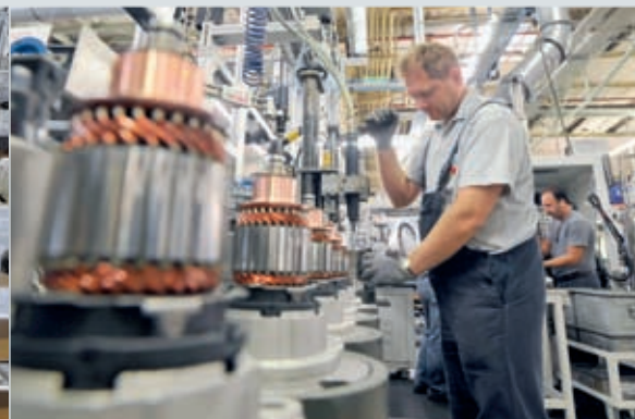
Am Fließband erfolgt die Aufarbeitung. Auch Altteile vom Wettbewerb werden bei Bosch zu neuem Leben erweckt
