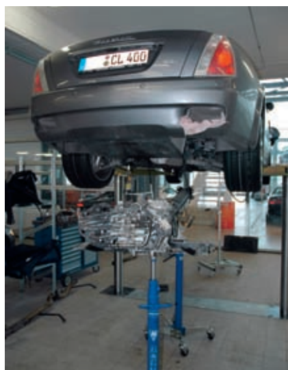
Auch für Maserati-Profis ein seltenes Bild ist der demonstrierte Transaxle-Antrieb eines Maserati Quattroporte
