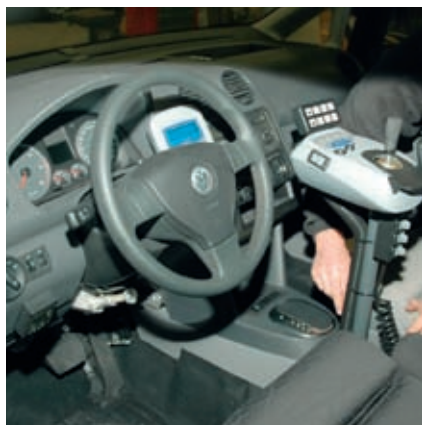
Das mehrfach ausgezeichnete Space-Drive-System ermöglicht Schwerstbehinderten die Steuerung per Joystick
