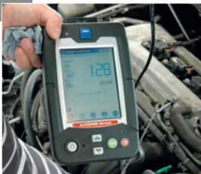
Anzeige einer Multimetermessung des Uniprobe-Moduls auf dem Display eines Texa Axone Direct
