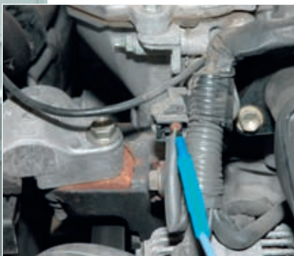
Mit den Mess-Spitzen lassen sich die Signale aus den Steckern und Anschlüssen aufnehmen
