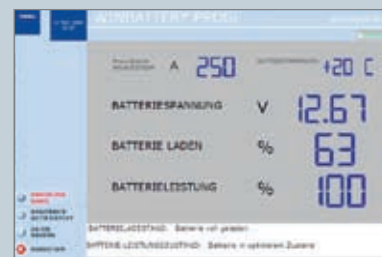
Ergebnisanzeige der „Battery-Probe-Funktion“ mit präziser Beurteilung der Batterie
