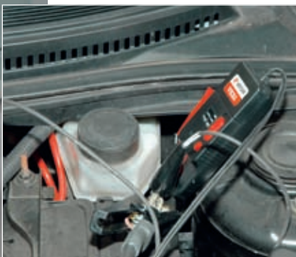
Mit den optionalen Strommesszangen lassen sich Ströme präzise ermitteln
