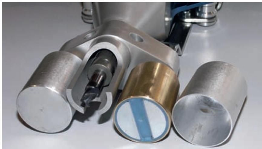
Zur Reinigung der Magnete von Spänen können die Aluminiumschutzhülsen von den Magneten gezogen werden
