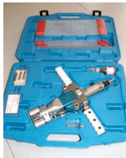
Das BWZ 100 wird zusammen mit einem Bohrer, Spannschlüssel und Bohrlöl (BTR Fluid, 50 ml) im Koffer geliefert
