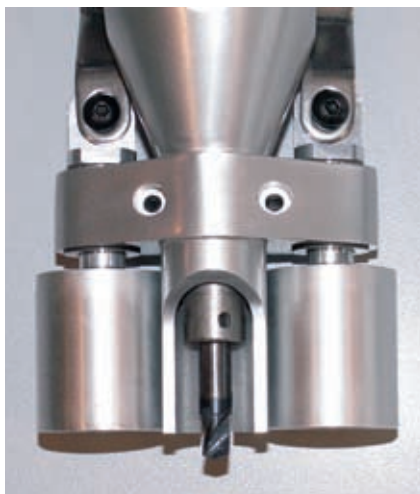
Die Tülle des Bohrers ist halbseitig aufgeschnitten
