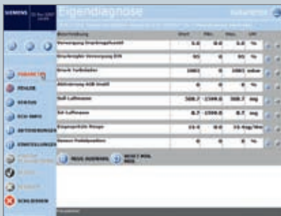
Anzeige der aus den Steuergeräten ausgelesenen Parameter mit passenden Einheiten
