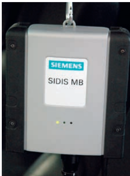
Das Diagnose-Interface wird an die Diagnoseschnittstelle angeschlossen über Bluetooth eingebunden
