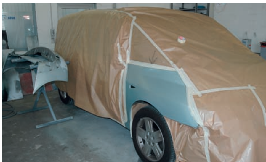
Der Klassiker: Das Beilackieren der Kotflügel nach einem Frontschaden ist handwerklich einwandfrei
