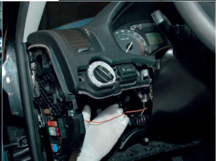
Die Stromversorgung erfolgt durch die Klemme-15 zum Sicherungskasten
