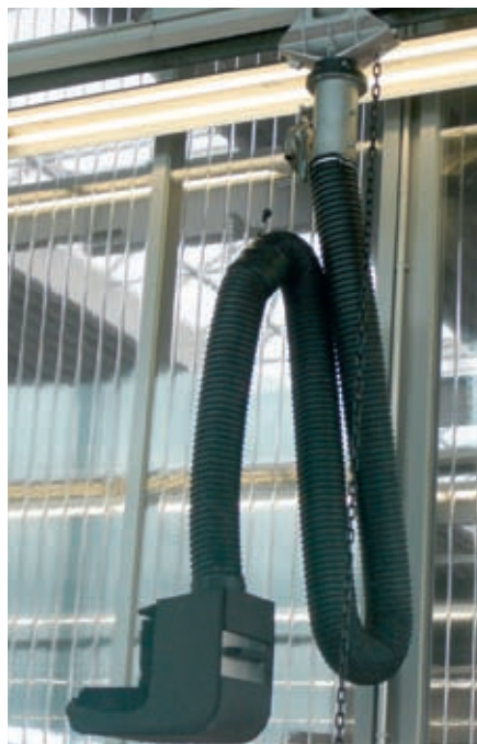
Bei Nichtgebrauch wird die Absaugöffnung im Fahrwagen automatisch verschlossen
