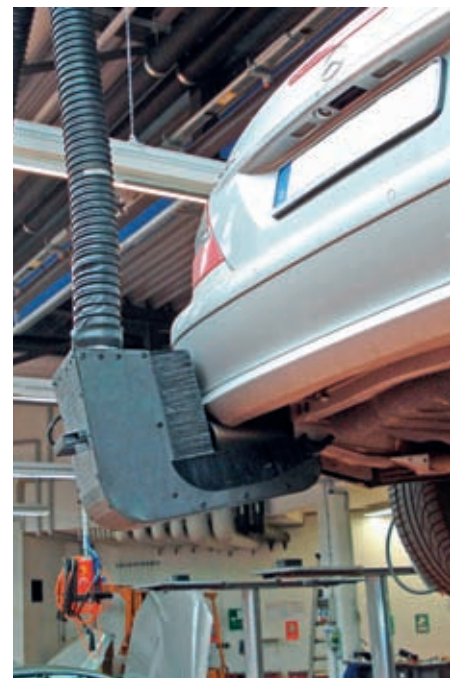
Die Saugereinheit verklemt sich mit dem Bürstenkämmen an jeder beliebigen Heckschürze
