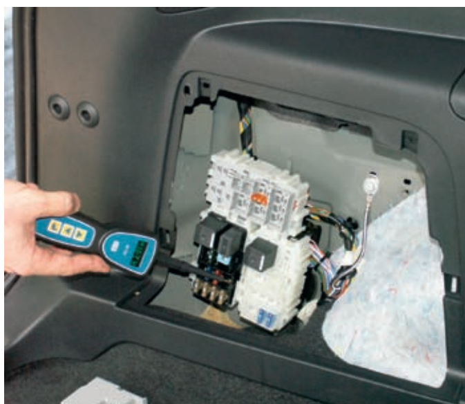
Die Suche nach einem Kurzschluss mit dem AZ 175 beginnt immer am Sicherungskasten eines Fahrzeugs.
