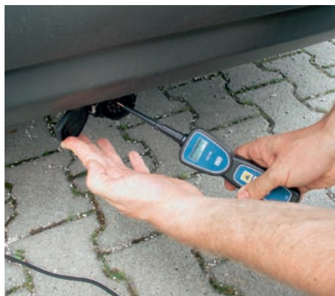
Mit der Prüfspitze des AZ 175 können die Kontakte des Anhängersteckers überprüft und den jeweiligen Beleuchtungselementen zugeordnet werden
