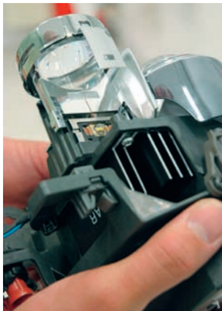
Sichtbarer Kühlkörper im geöffneten und teilweise zerlegten LED-Scheinwerfer des Lexus LS 600h
