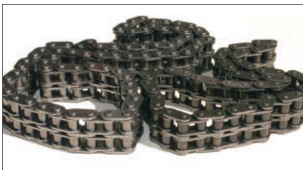
Doppelrollenkett en: erste Wahl bei Motoren mit großem Hubraum und hoher Leistung (Beispiel: Reihensechszylinder von Mercedes-Benz)
