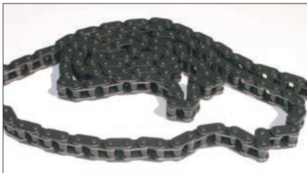
Einfache Rollenketten finden meist bei Motoren mit geringem Hubraum und vergleichsweise niedriger Nennleistung Verwendung
