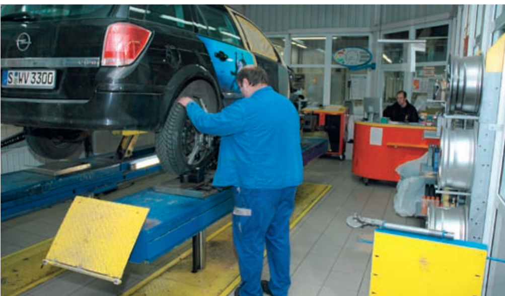
Werkstattleiter Mladen Jankovic, im Bild links und im Hintergrund am PC sichtet in der Direktannahme die Auftragslage. Sein Kollege im Vordergrund führt eine Achsvermessung durch.
