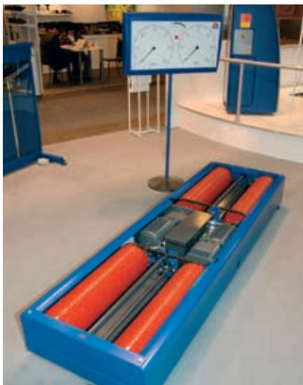
MAHA bringt den neu entwickelten Basis-Rollenbremsprüfstand MBT 2100 mit auf die IHM
