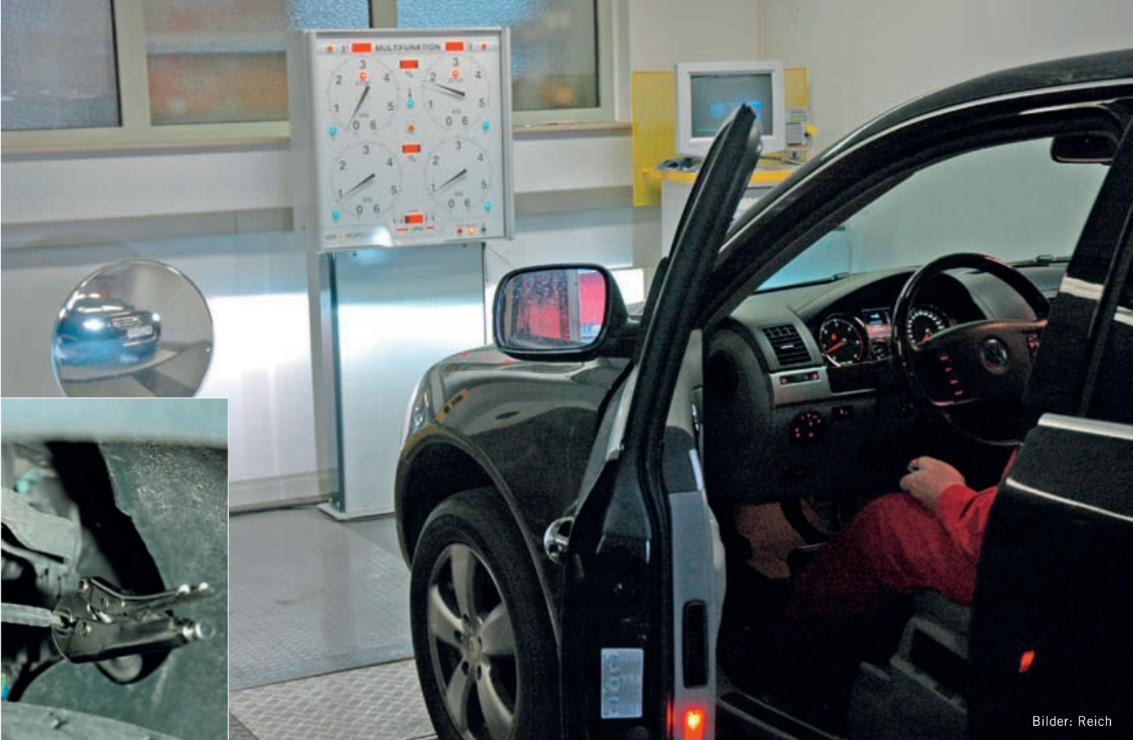
Der alte Kniff mit dem abgesperrten Bremsschlauch wird ausdrücklich nicht zur Nachahmung empfohlen, ist aber sehr praktisch
