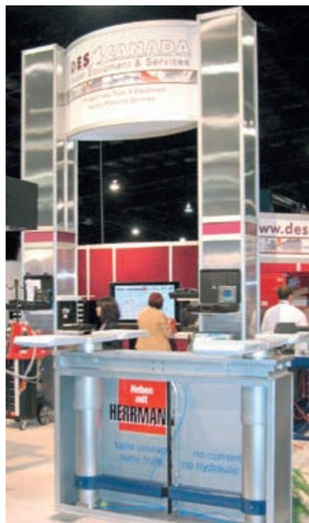
Mit Wasser statt Hydraulik-Flüssigkeit arbeitet der Aqualift von Herrmann aus Pöding
