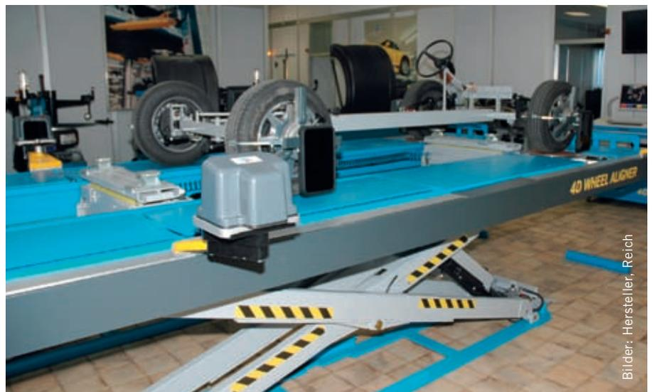
Präzision und Schnelligkeit bietet das in die Bühne integrierte Fahrwerksvermessungssystem von Ravaglioli
