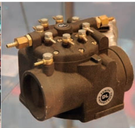
Pierburg-DL-Einspritzung, verwendet bei Alpina, gesehen beim Bosch Classic Service Küppers
