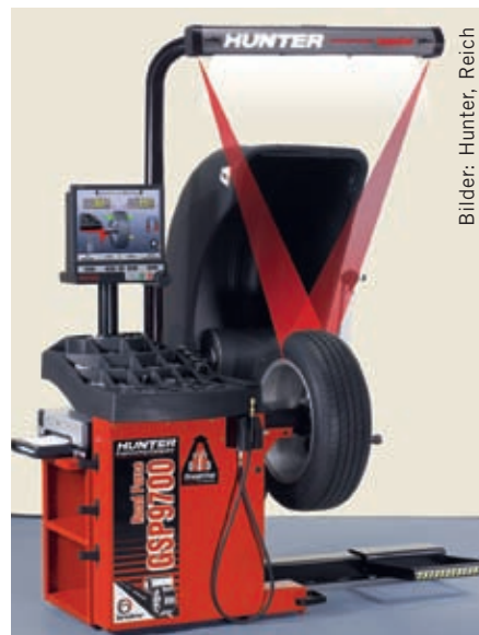
Hammer Head nennt sich die neue, automatisch aktivierbare Positionierhilfe für Schlaggewichte
