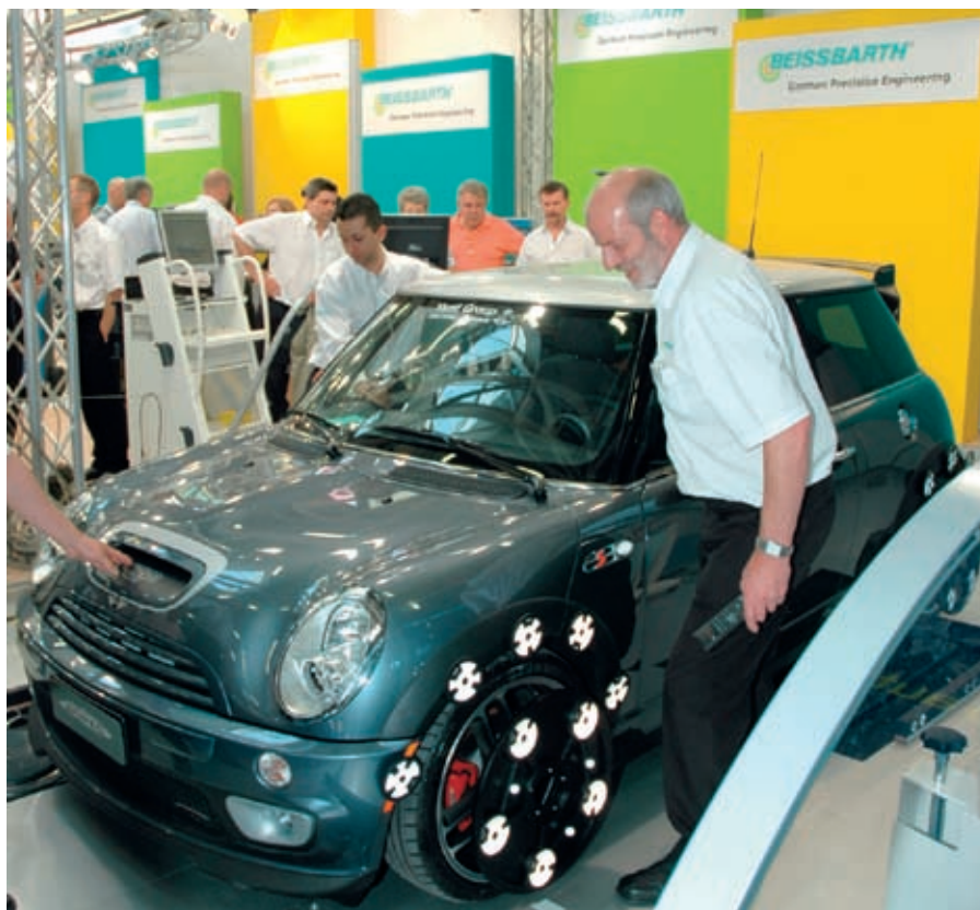
Systeme für die Fahrwerksvermessung, hier das Beissbarth-Kamera-System
