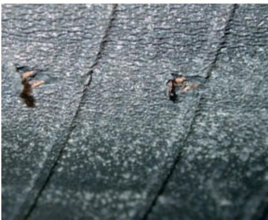
Wer die Grundsätze der wdk-Anleitung missachtet, riskiert u. a. Schäden am Innerliner
