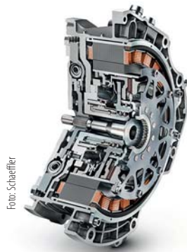
Das P2-Modul verbindet E-Antrieb und Kuppelung mit dem Getriebe.
