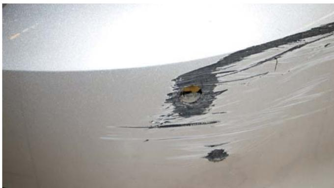
Hier hat es den PDC-Sensor direkt erwischt. Es wird eine konventionelle Unfallinstandsetzung durchgeführt.
