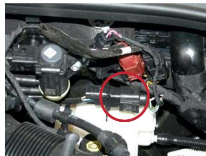
Der Steckverbinder der Sonde liegt direkt über dem Bremsflüssigkeitsbehälter.
