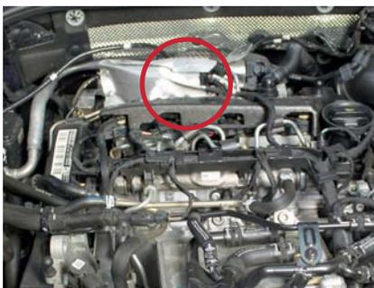
Die Lambdasonde im Passat befindet sich hinter Motor und Turbolader vor dem Katalysator.
