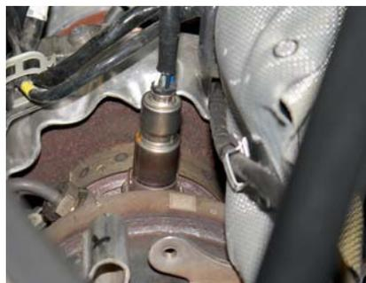
Die Lambdasonde lässt sich beim Austausch mit einem Sechskantschlüssel lösen.
