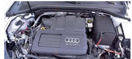
Der 1.4-TFSI-Motor des Audi lässt sich sowohl mit Erdgas als auch Benzin betreiben.
