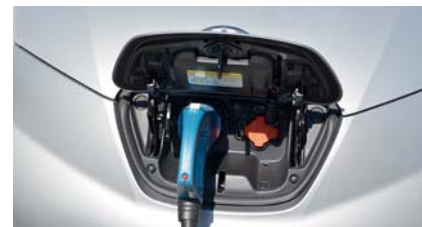
An der Motorhaube findet sich eine Klappe, unter der die Ladebuchsen zu finden sind.
