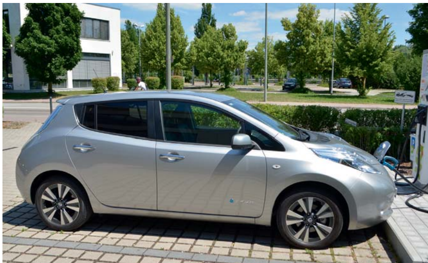
An einer Schnell-Ladesäule ist der Nissan Leaf nach einer halben Stunde auf gut 80 Prozent Batteriekapazität aufgeladen. Danach geht das Laden deutlich gemächlicher.
