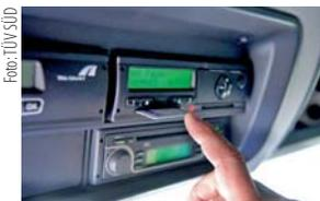
nicht nur Angaben zur Identität des Fahrers hinterlegt, sondern es werden zudem alle Lenk- und Ruhezeiten für mindestens 28 Tage gespeichert. Jeder Lkw- oder Busfahrer darf nur eine einzige Fahrerkarte besitzen. Sie muss alle fünf Jahre erneuert werden, stets aktuell sein und für Kontrollen mitgeführt werden. Unternehmen benötigen die Unter-
