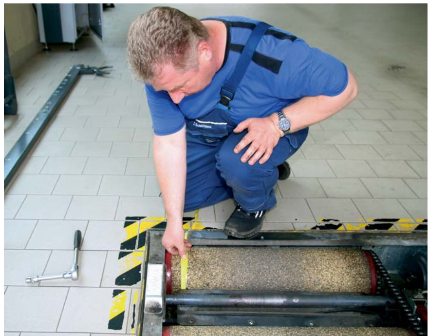
Kalibrierung: Ein TÜV SÜD Experte misst zunächst den Rollendurchmesser des Bremsprüfstandes.
