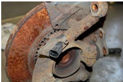
Ein Klassiker: Die Schraube des ABS Sensors ist festgerostet. Der Ausbau kann sich über Stunden ziehen.
