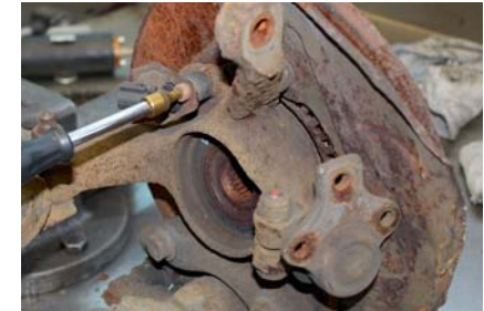
Ergebnis: Nach wenigen Minuten Wartezeit bis zur Abkühlung kann die Schraube ganz einfach aus dem Gewinde gedreht werden.
