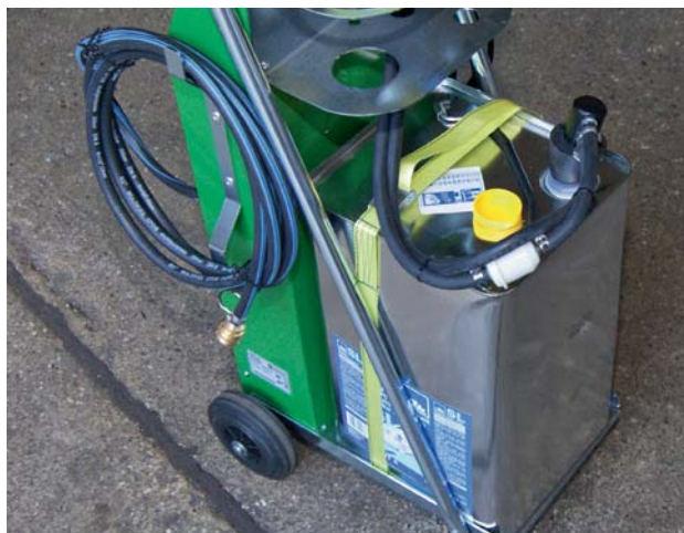
Das BMB-Tool kann mit einem 20-Liter-Kanister Bremsflüssigkeit bestückt werden. Genug für bis zu hundert Bremsflüssigkeitswechsel.
