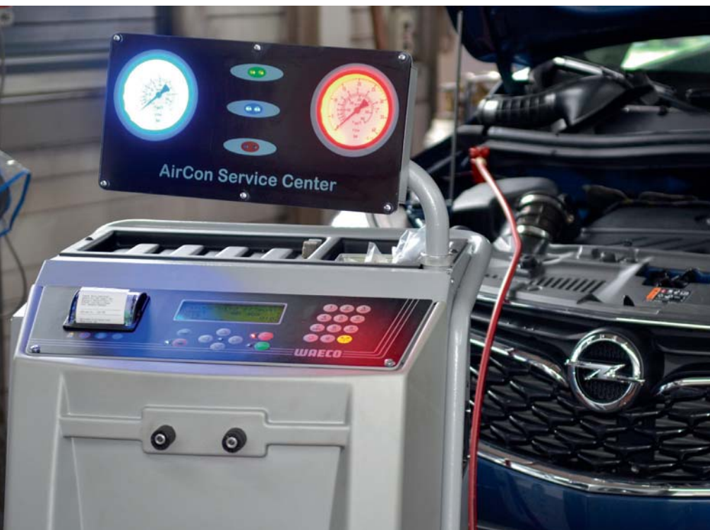
Das Klimaservicegerät Waeco ASC 5000 RPA für R1234yf ist seit einem Jahr im Einsatz.
