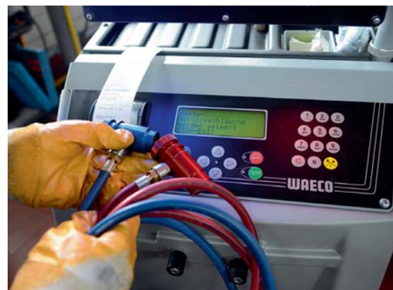
Die speziellen Anschlüsse erleichtern das Befestigen und verhindern Kältemittelaustritt.
