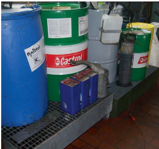
Umweltschutz wird bei Partslife großgeschrieben. Vorschriftsmäßige Auffangwannen unter den Ölfässern.
