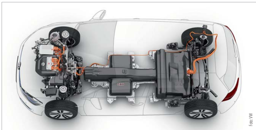
Die Batterie des E-Golf ist unter den Vorder- und Rücksitzen sowie im Mittelunnel untergebracht.
