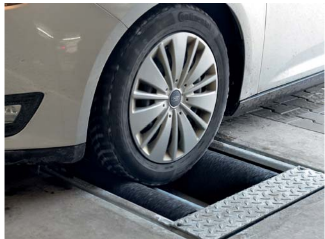
Der neue Prüfstand verfügt über einen vollautomatischen Prüfablauf. Der Rollensatz entspricht dabei den Details der HU-Bremsenrichtlinie.
