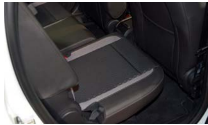
Pfiffig: Die Fondsitze lassen sich um 150 Millimeter in Längsrichtung verschieben.
