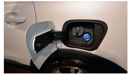
Unter dem Tankdeckel befindet sich auch eine AdBlue-Nachfüllmöglichkeit.
