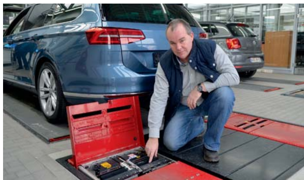
Beim Überfahren startet der bodeneben verbaute Reifenprofiliefenmesser automatisch.
