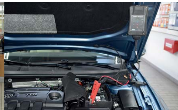
Der Midtronics Batteriecheck ist ebenfalls in den Prüfablauf integriert.
