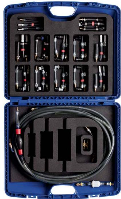
druck von 2.500 bar durchgeführt werden. Die digitale Druckanzeige ist mit einem 2,5 Meter langen Kabel ausgestattet, so dass sowohl der niedrige Startdruck im Stand als auch der Hochdruck während der Fahrt genau abgelesen werden können. Flexible Schläuche und optional erhältliche abgewinkelte starre Adapterleitungen erlauben dabei auch eine Prüfung des Hochdruckbereichs an schwer zugänglichen Stellen.
