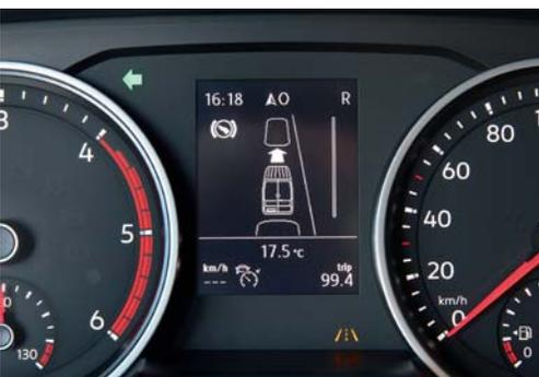
Einparkhilfe: Das Display zeigt, wann der Gang gewechselt werden muss.
