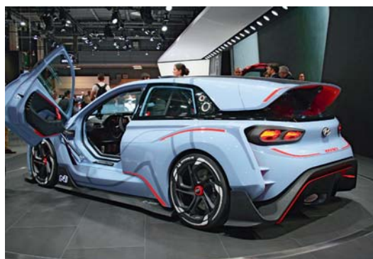
Bei Hyundai wird an den kommenden N-Sportmodellen gearbeitet. Quasi als Forschungs-Conceptcar wird dabei das RM Concept stetig weiterentwickelt. Dieser hier bringt mit einem Zweiliter-Vierzylinder-Turbomotor rund 300 PS und 383 Nm Drehmoment.
