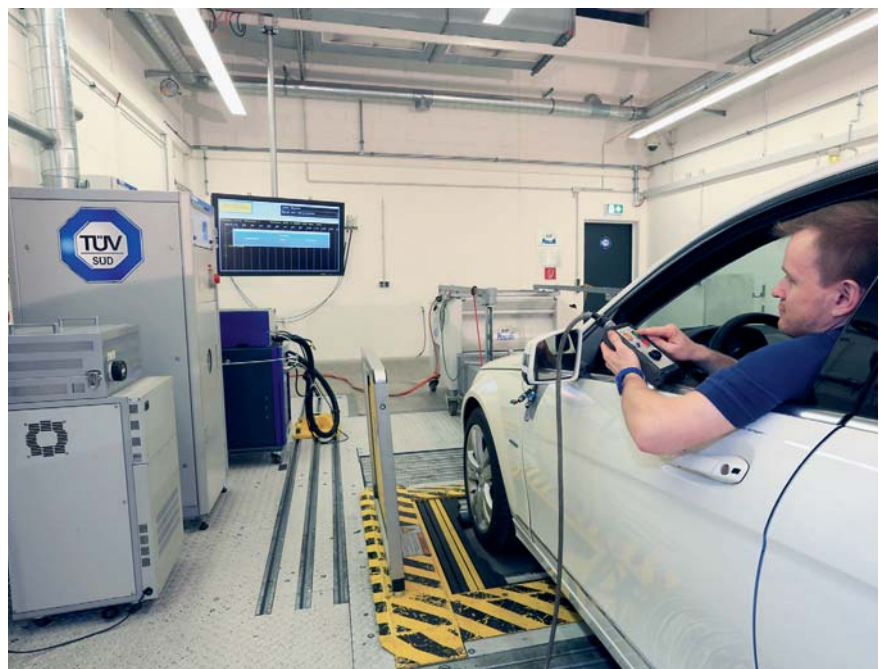
Vorbereitung für eine Abgasmessung auf dem Rollenprüfstand im Abgaslabor Heimsheim
