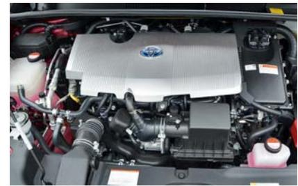
Der 1,6-Liter-Benziner im Prius leistet 98 PS und 142 Newtonmeter Drehmoment.
