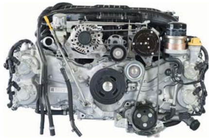
Bei einem Boxermotor sind die Zylinder platzsparend gegenüber angeordnet.
